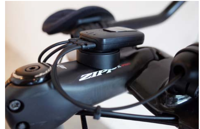
Gebogene, selbstklebende Halterung an Lenkervorbau befestigt
