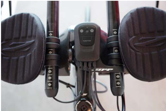
22,2-mm-Halterung an Aero-Verlängerung befestigt
