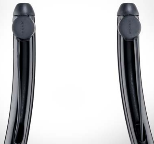
Blips an der Unterseite der Aero Verlängerung ohne Lenkerband montiert.
