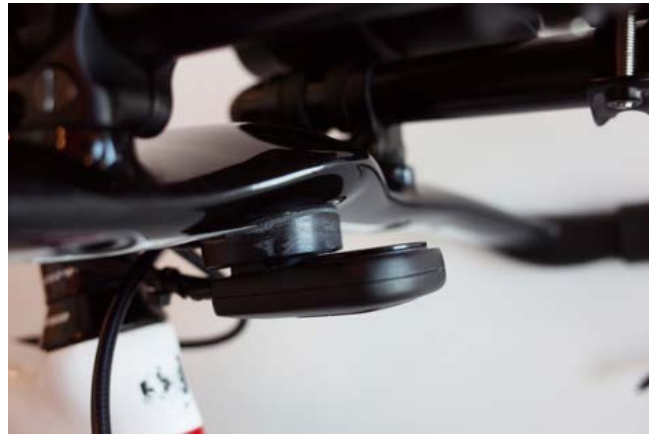
Gebogene, selbstklebende Halterung unter Basislenker befestigt
